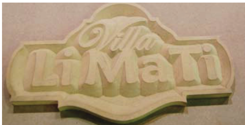
Maszyna radzi sobie z wykonaniem grawerowanych napisów na płytach. FOT. JANUSZ BEKAS
