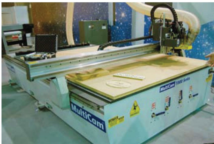
Centrum posiada stabilny korpus, a stół roboczy wykonany jest jako sztywna konstrukcja aluminiowa. FOT. JANUSZ BEKAS
