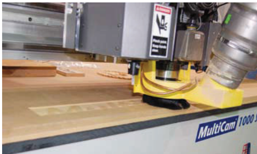
Wióry i pyły z procesu frezowania są natychmiast odciągane. FOT. JANUSZ BEKAS
